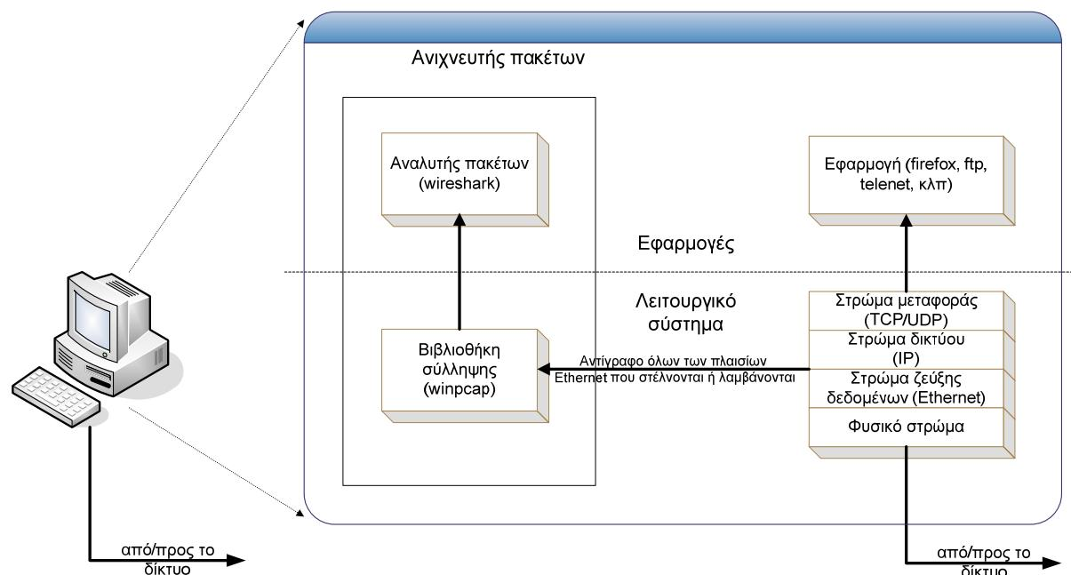
Στο παραπάνω σχήμα βλέπουμε τη στοίβα πρωτοκόλλων TCP/IP, καθώς επίσης, και διάφορες συνήθεις δικτυακές εφαρμογές που εκτελούνται σε ένα υπολογιστή, όπως ένας πλοιηγός ιστού ή πελάτης FTP. Ο ανιχνευτής πακέτων, που παριστάνεται με το διαγραμμισμένο πλαίσιο στο σχήμα, είναι μια προσθήκη στο λογισμικό του συστήματος όπου εκτελείται και αποτελείται από δύο τμήματα: α) τη βιβλιοθήκη σύλληψης πακέτων και β) τον αναλυτή πακέτων.
